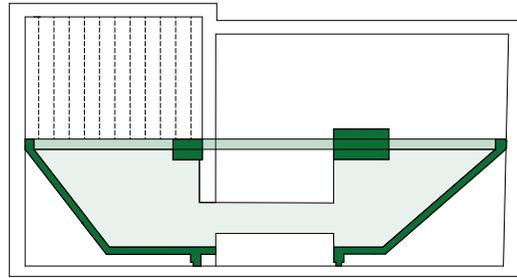
Der mittigen Tragachse folgend werden die Dachlasten über Betonträger in Kreisbogen und Kreuzstruktur eingeleitet. Der Kamin wirkt hierbei als stabilisierende Hängestütze.
