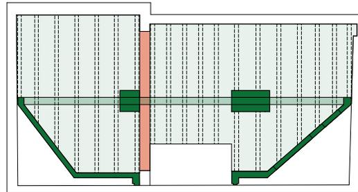
Die alte Balkenlage wird durch den Betonüberzug zu einer wirksamen Hybriddecke verbunden. Rückwertig angeordnete Betonscheiben erlauben das Wegschneiden grosser Deckenpartien um zenitales Licht einzuführen.
