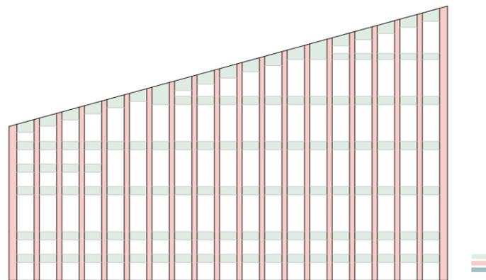
Betongridd der Fassade mit aussteifenden Betonkränzen
