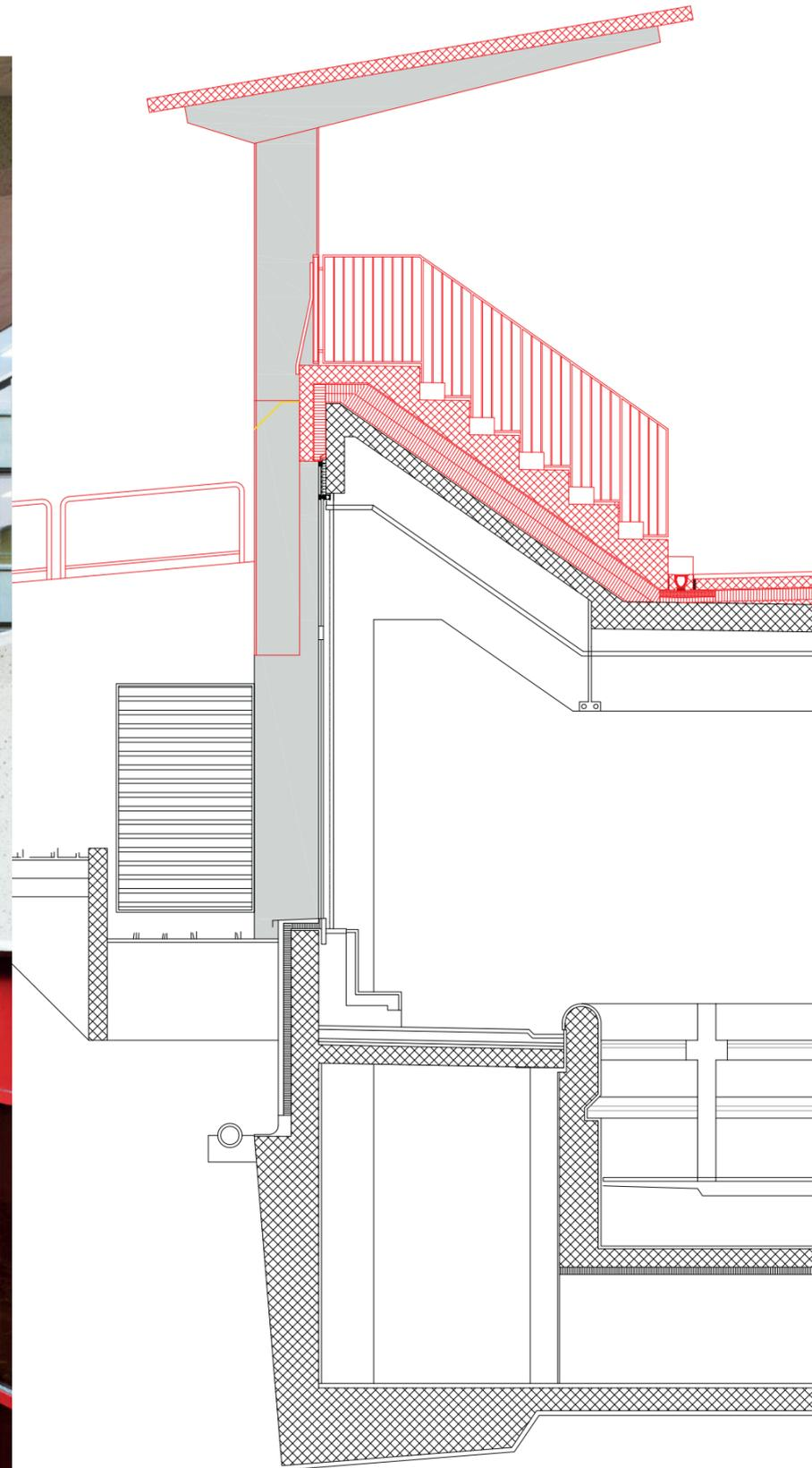
Die Kragdächer der beiden Tribünen wurden direkt auf die bestehenden Fassadestützen aufgepfropft. Da diese nur wenig mehr als sich selbst zu tragen haben, war es möglich, am Bestand weiterzustricken.
