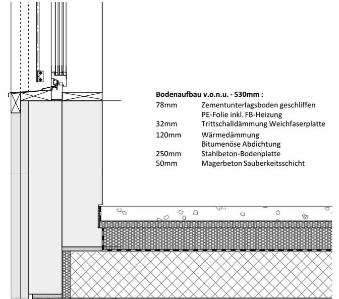
**Bodenaufbau v.o.n.u. - 530mm :**
