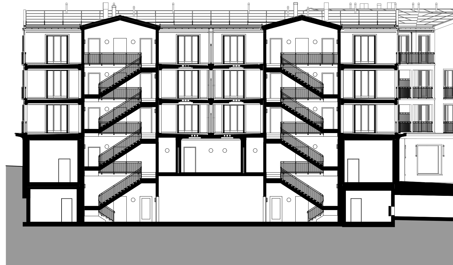
Längsschnitt Treppenhaus Haus A
