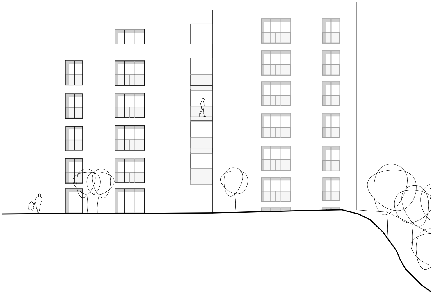
Elévation façade pignon bâtiment 3 1:200
