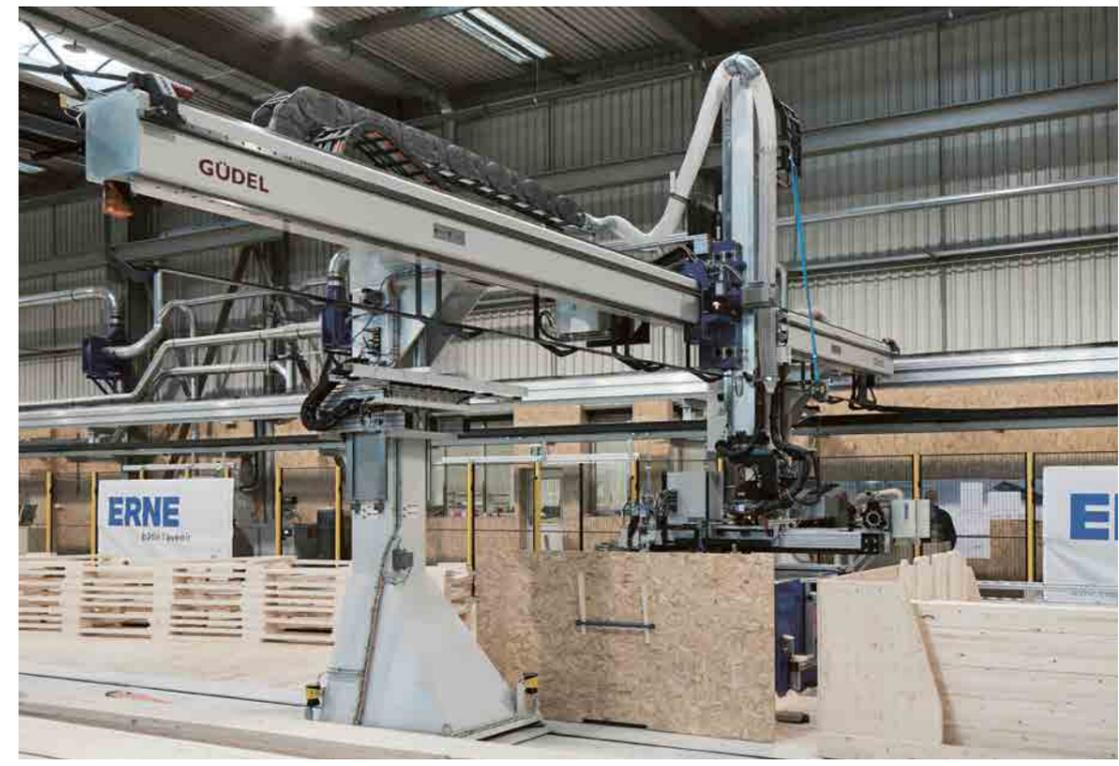
Automatische Erstellung der Maschinensteuerungs-Daten für die Elementfertigung mit dem ERNE-Portalroboter.
