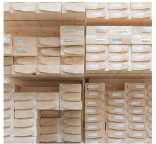
Balken mit Schwalbenschwanzverbindungen
