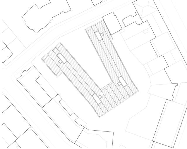
Grundriss Strukturplan Primär- und Sekundärkonstruktion M 1:500
