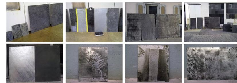
Die Fassaden- und Dachverkleidung besteht aus geätzten feuerverzinkten Stahlplatten. Entwicklungsweg der Gestaltung im Atelier Sonderegger
