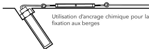
Utilisation d'ancrage chimique pour la fixation aux berges
