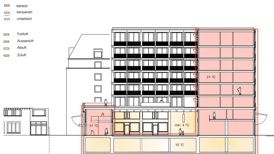
Querschnitt 1:500 – Klimazonen und Dämmperimeter
