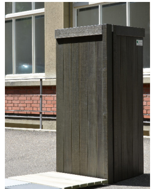
Façade en bardage sapin autoclavé, huilé maquette 1:10 échantillon 1:1 de l'angle
