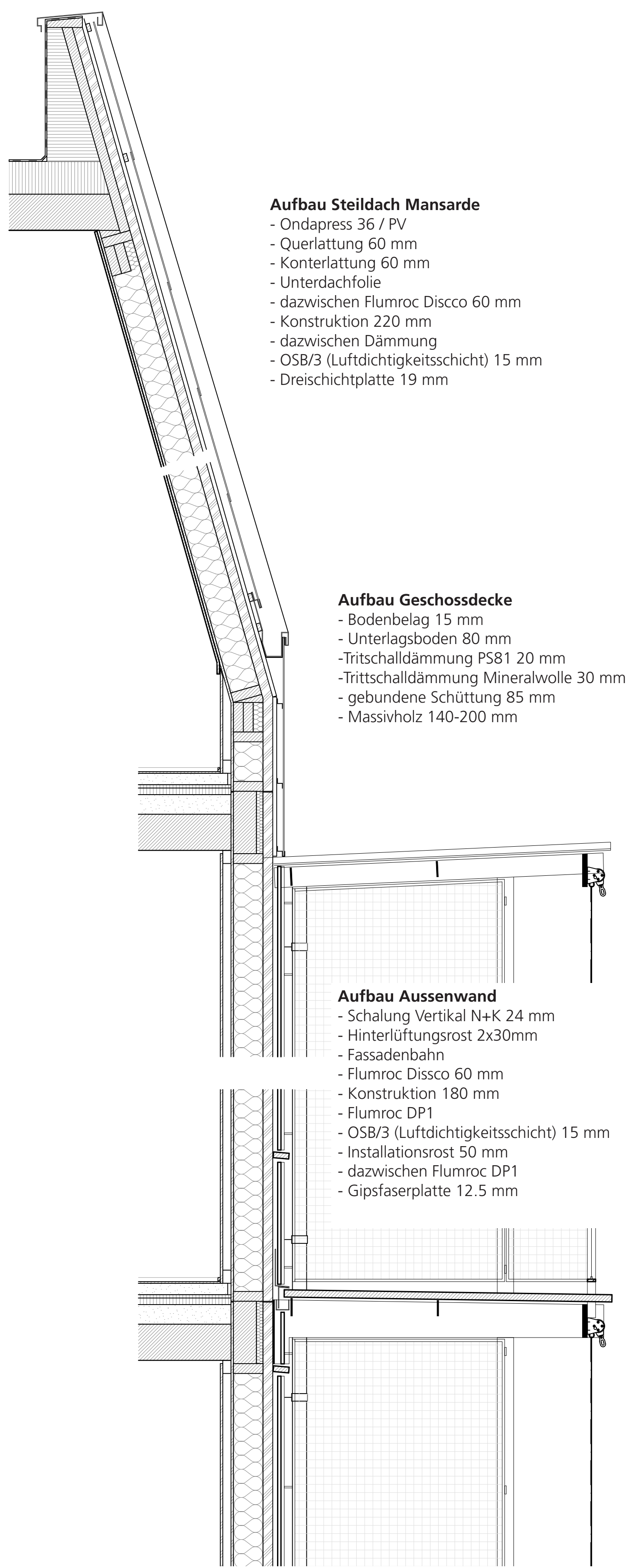
Detail Wand- und Deckenanschluss 1:20
