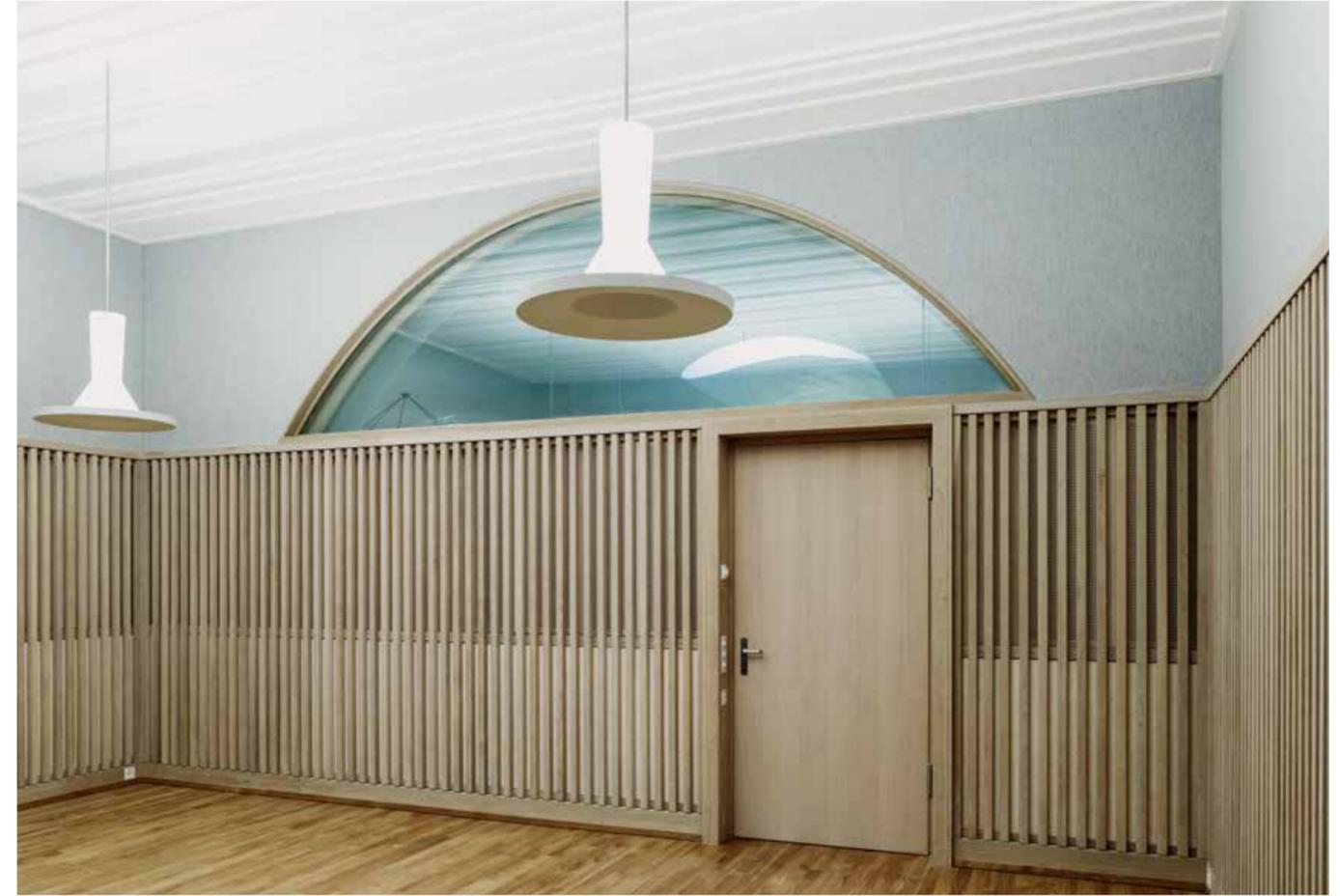
Sopra: l'interno di una sala per gli strumenti a percussione. Il pavimento è realizzato in rovere, mentre per le pareti sono stati impiegati pannelli in legno e stoffa in modo da garantire una perfetta acustica
