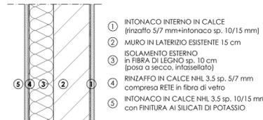
DETTAGLIO PARETE PERIMETRALE ESISTENTE P.T. e P.1° - NORD/OVEST - scala 1:10
