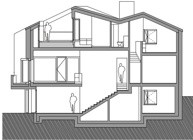
Längsschnitt Treppe Eingangsgeschoss 1:200
