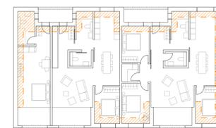
Schéma des décaissements en dalle
