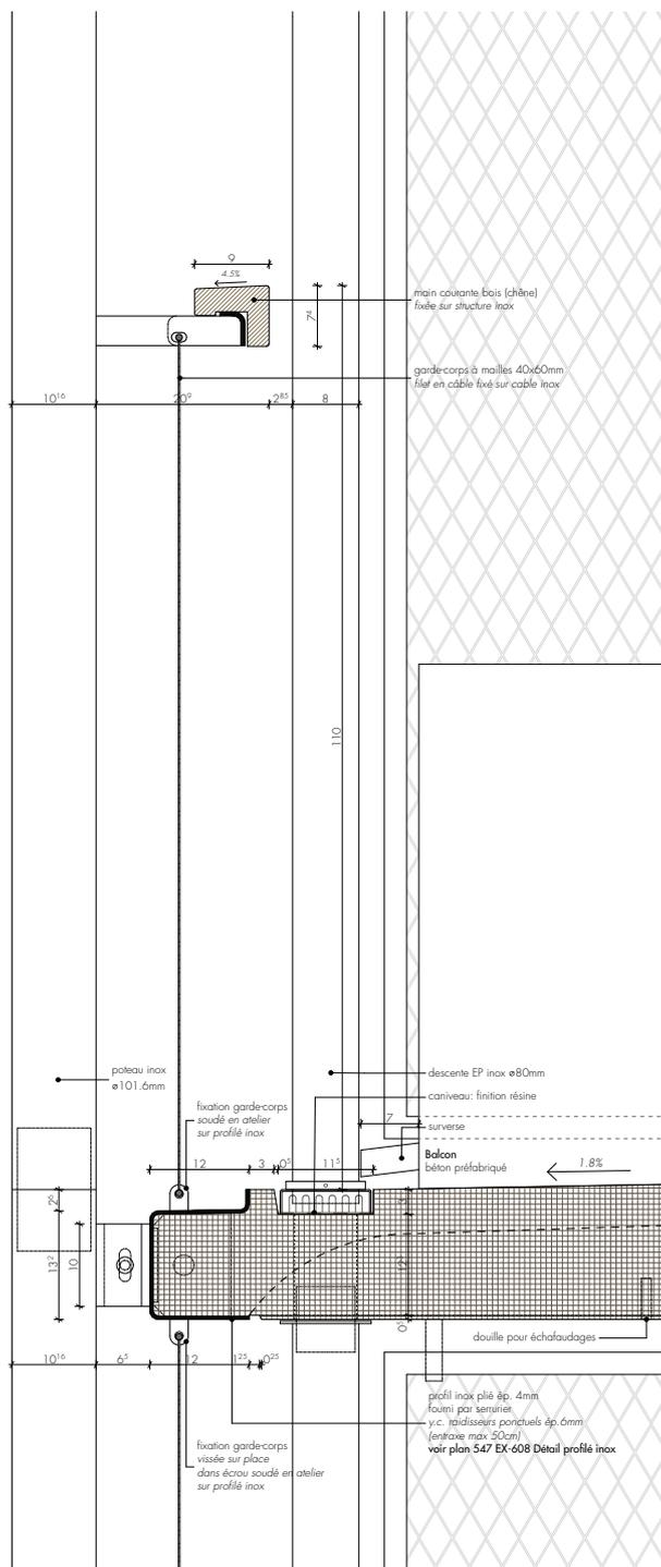
Assemblage balcon - profil inox - poteaux inox et descentes EP
