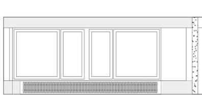
Die Fensterbank werden frontal seitlich mit MDF grundfoliert verkleidet und silbrig gestrichen (RAL 9006 Weissaluminium metallisch). Die Radiatoren werden in selben Ton gestrichen/geputzt. Die Fensterbank selbst wird angeschliffen und im selben Ton gestrichen. Das dunkle Holz wird zur Aufhellung in Weiss RAL 9016 gestrichen. Die Übergänge (an der Stelle wo die Wände abgebrochen werden) werden etwas begründet und nicht überstrichen – somit kommt das rohe Baumaterial zum Vorschein.
