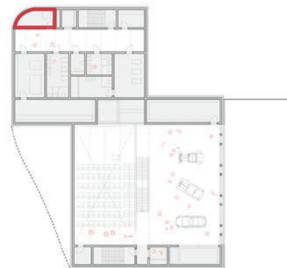
Local électrique au sous-sol
