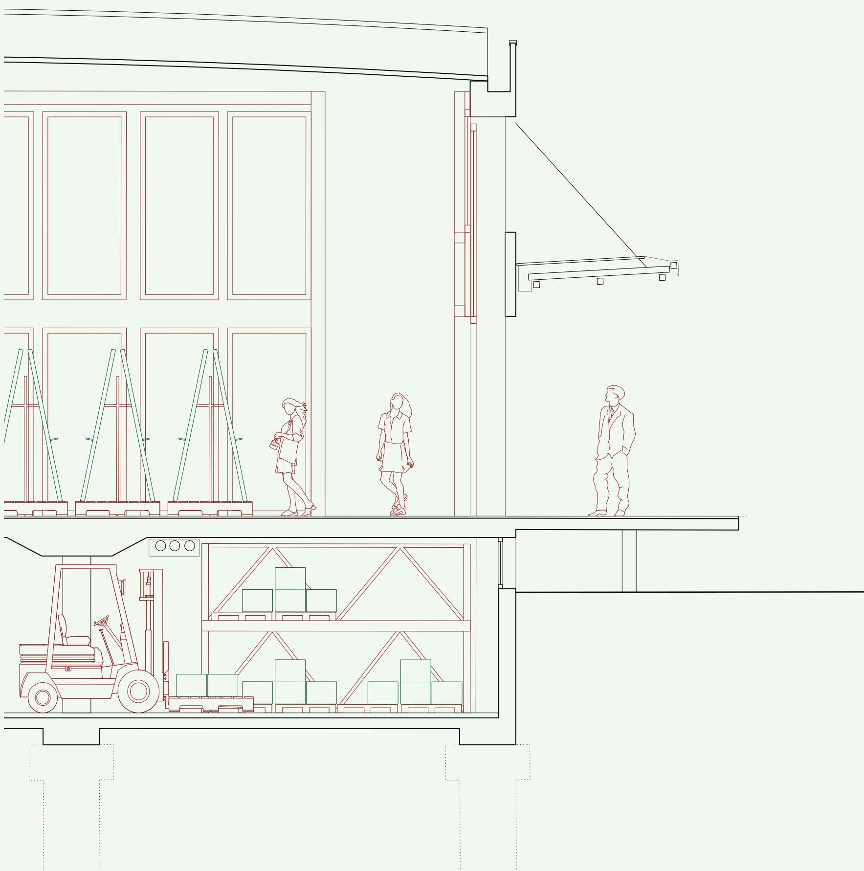
Fassadenschnitt & Ansicht Bestehende Güterhalle
