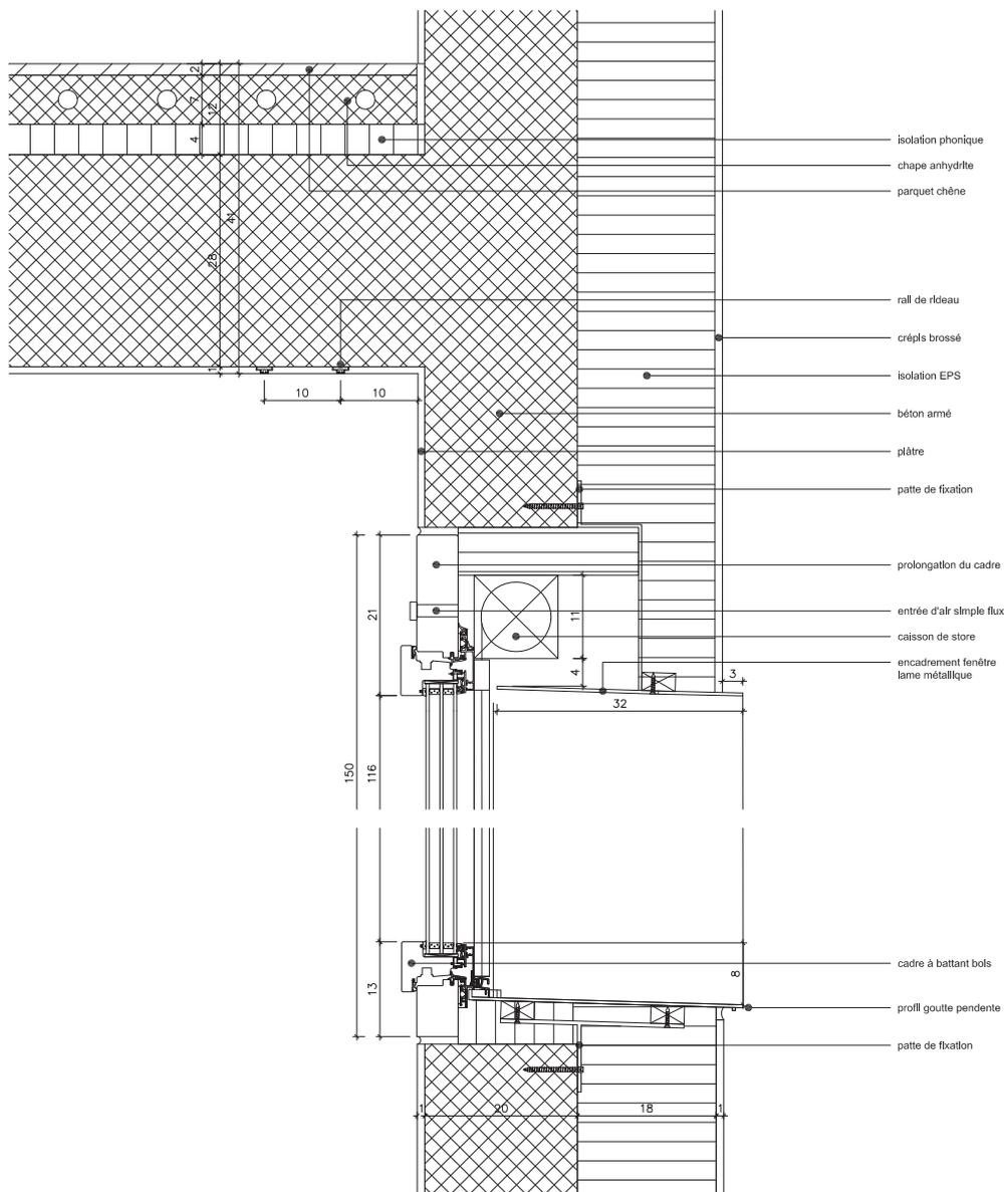
Fenêtre affleurée sur l'intérieur avec encadrement métallique / 1:10<sup>ème</sup>
