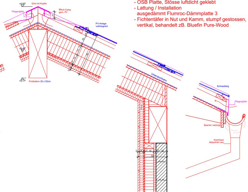
Detail Dach PV-Anlage 1:20
