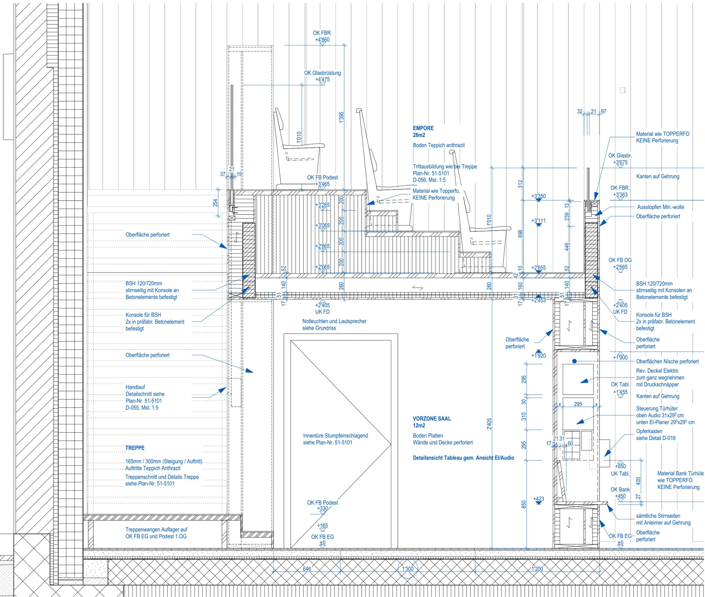
sämtliche Holzbauarbeiten werden auf dem fertig verlegten Plattenboden errichtet.
