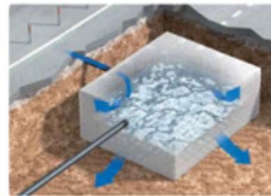
Wasserrückhaltebecken mit Boden Versickerungssystem
