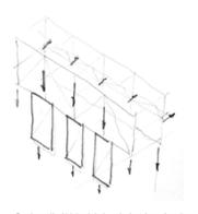
Strukturelle Abhängigkeit zwischen bestehender und neuer Struktur: Horizontale Aussteifung des Einbaus über punktuelle Verbindungen zum Mittelgurt der bestehenden Aussenwände.
