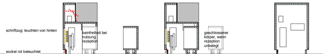
querschnitte m1:50: arbeitsfläche mit klappen arbeitsfläche mit schieber "kubus"
