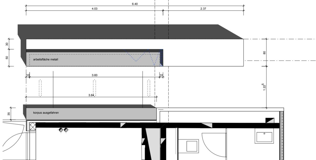
materialisierung v1: corian oder staron o.ä., homogen gefügt, fugelos, bright white
