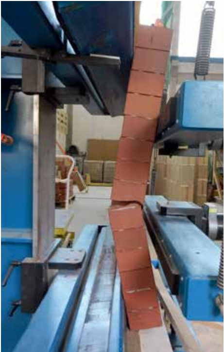
Versuche Biegefestigkeit x-Richtung, p+f Sursee
