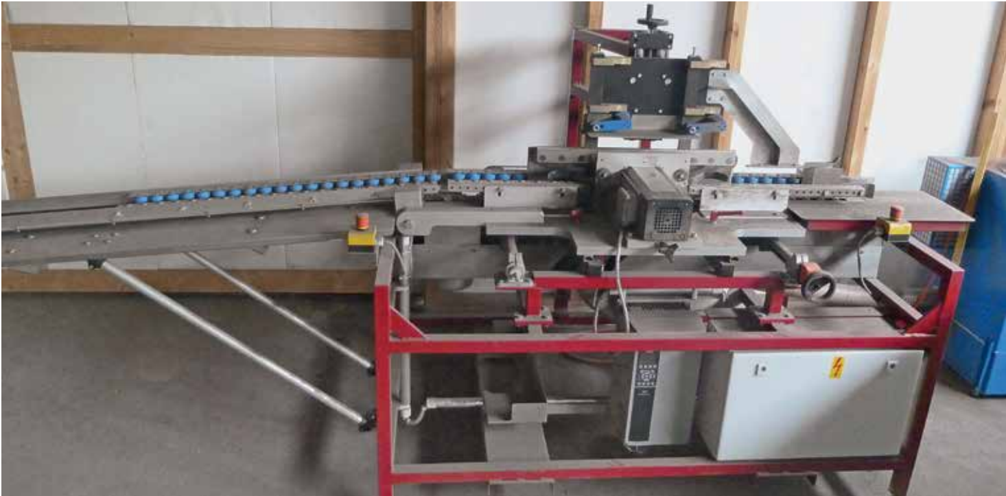
Kalibriermaschine für Klinkersteine (Genauigkeitsbereich +/- 0,1 mm)
