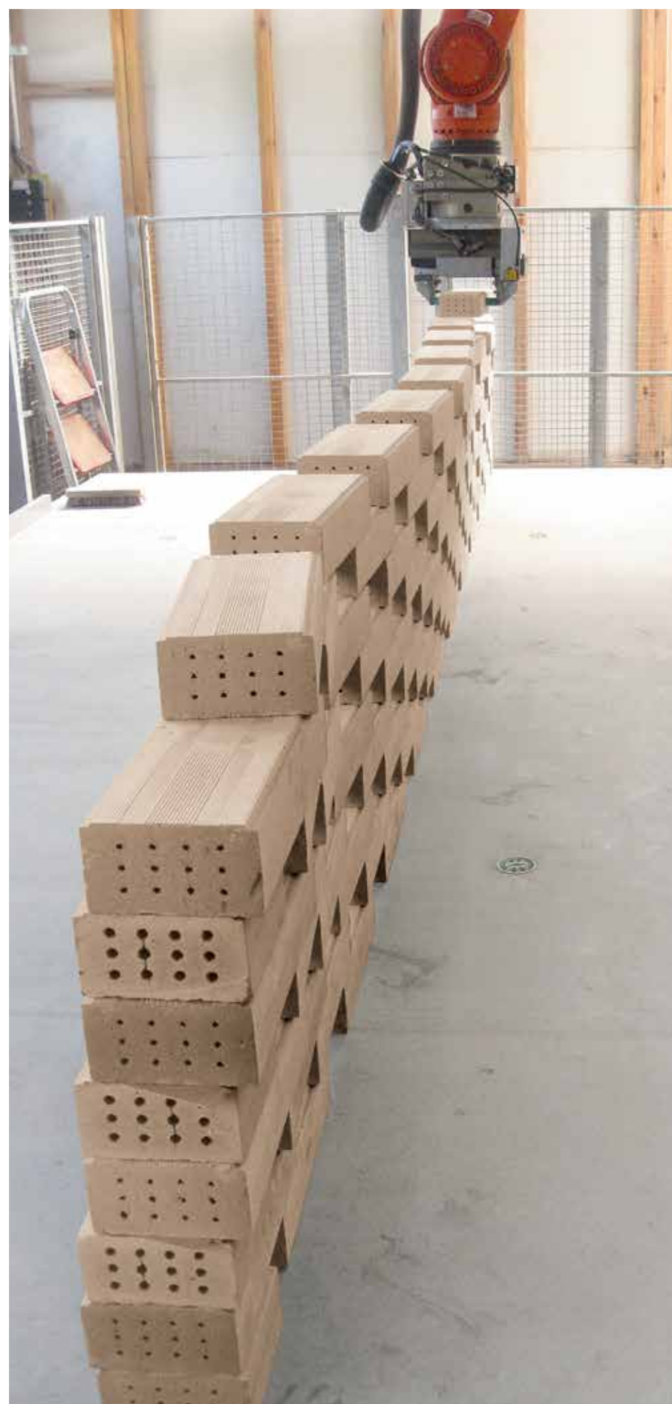
Bild 4 – ROBmade Fassadenelement in Produktion
