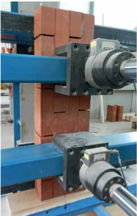
Versuche Biegefestigkeit y-Richtung, p+f Sursee
