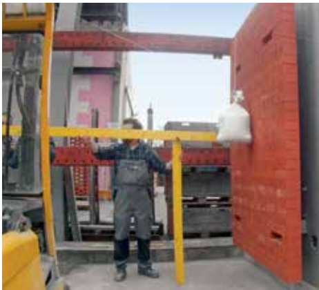
Anprallversuche Schockbelastung N y > 240 Nm
