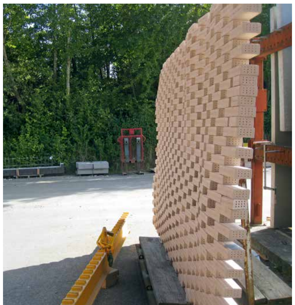
Bild 5 – Fertig fabriziertes ROBmade Fassadenelement im Vorfabrikationswerk
