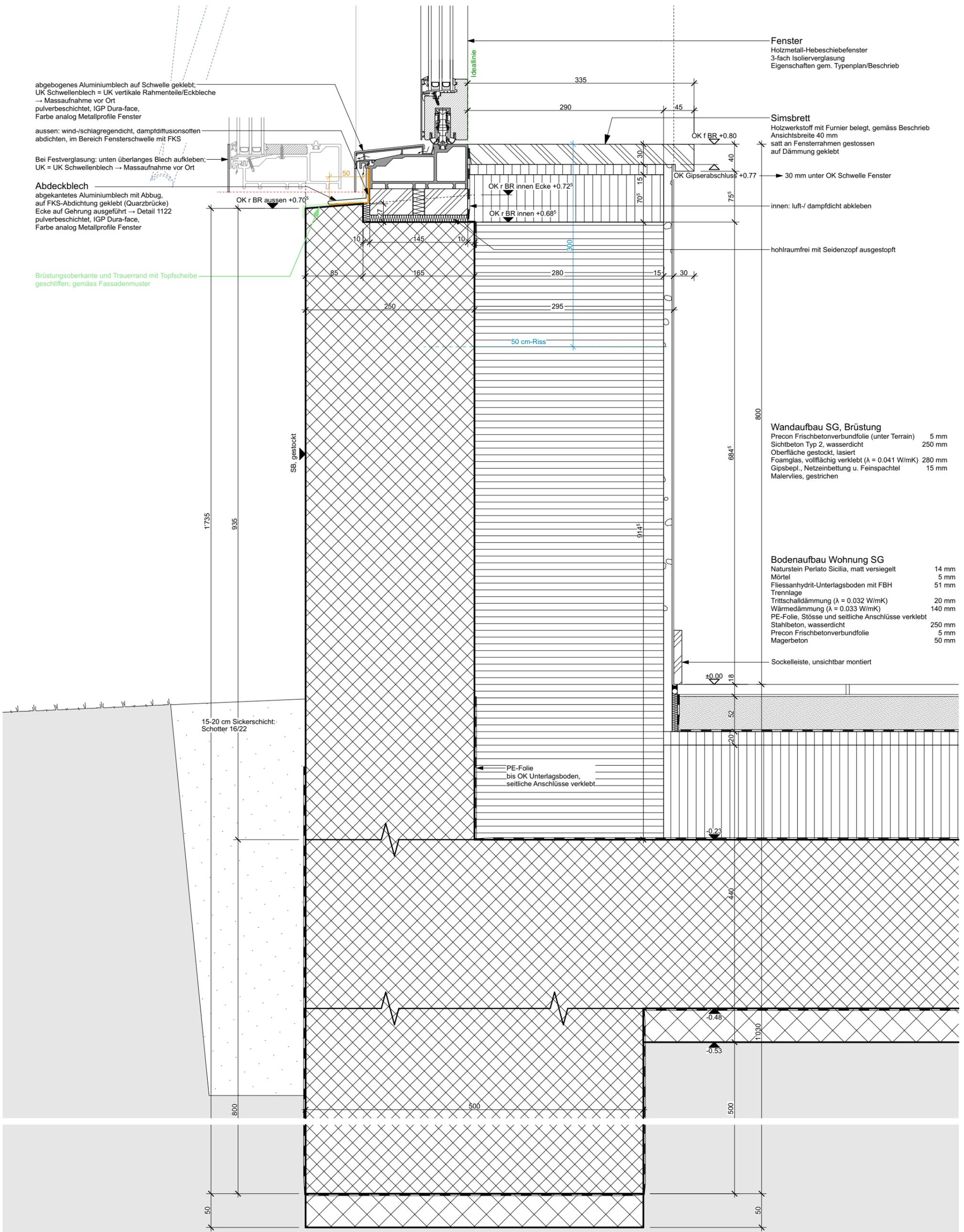
abgebogenes Aluminiumblech auf Schwelle geklebt;
