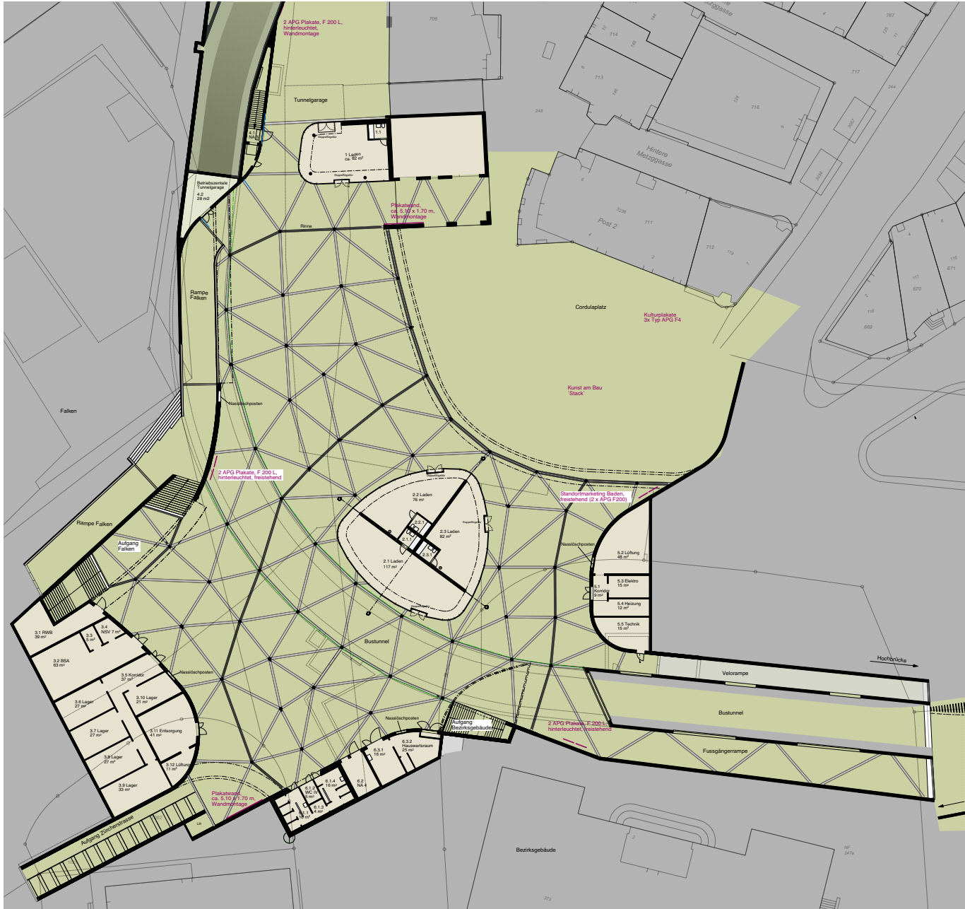
Plan der neuen Cordulapassage unter der Verkehrsebene. In der Mitte ein freistehender Ladenblock, im Süden Serviceräume, die neue WC-Anlage und im Norden ein weiterer Ladenblock.
