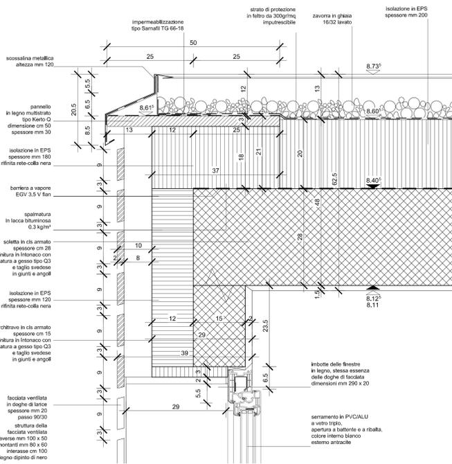
Dettaglio E - Finestra con architrave in beton 1:5
