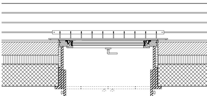
Detailgrundriss Horizontalschnitt Kniestock mit Bodenfenster 1:20
