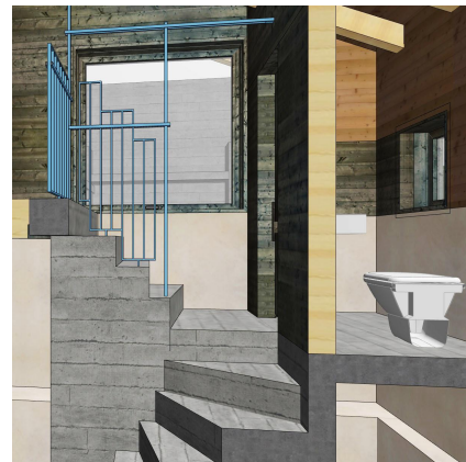
3D-Treppenschnitt (Richtung Norden)
