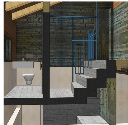
3D-Treppenschnitt (Richtung Süden)
